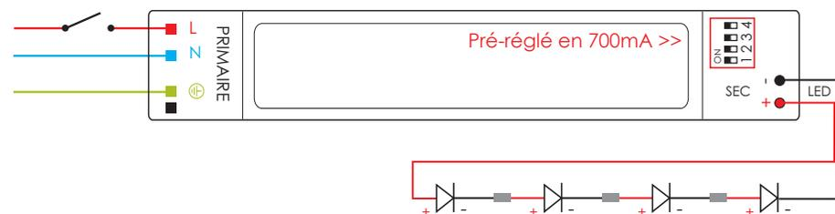
Raccorder vos spots en série sur l'entrée secondaire du convertisseur (SEC + et -), puis raccorder le Neutre (N), la Phase (L) et la Terre (T), l'interrupteur ouvre le circuit de la Phase.
